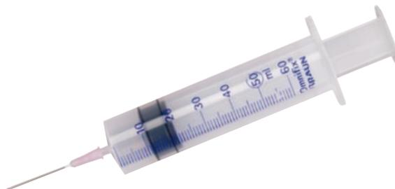
Limsprøjte med nål til efterlimning af loft og vægbeklædninger, hvor man efter tørring finder mindre buler.
